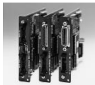
GPIBインターフェース(IB11) RS-232Cインターフェース(RS11) マルチ・チャンネル・バス(MC11S)
